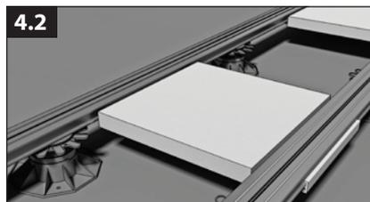
Verwendung von Plattenankern zwischen den Stellfüßen und Auflegen von Betonplatten (Plattenanker entsprechend der Plattendicke oder immer 50er)
