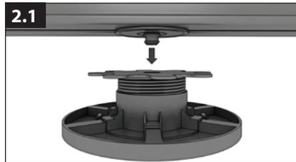
Montage durch Einschieben der Adapterplatte in die UK und anschließendem Einklippen in den Stellfuß. Mittlerer Abstand der Stellfüße: 65 cm max.
