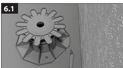
Um den maximalen Überstand von 5 cm einzuhalten, muss der Auflageteller u.U. seitlich gekürzt werden.
