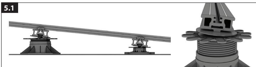
Winkelausgleich: Der Fuß gleicht Winkel von bis zu 5 % in alle Richtungen aus.
