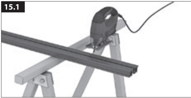
15.1 Zuschneiden der UK-Profile.
