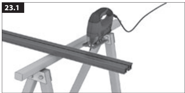
Zuschneiden der UK-Profile.
