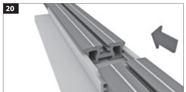
20 Verlegung der UK-Profile auf Stoß. Plattenanker im Stoßbereich unterlegen.
